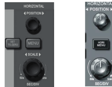
Fig.1.10 Zona de Control Horizontal sobre el Panel Frontal.
