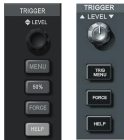
Fig.1.11 Zona de control del menú de disparo sobre el panel frontal
