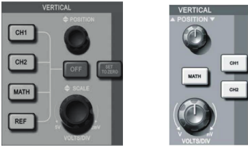
Fig.1.9 Area de control vertical en el panel frontal.
